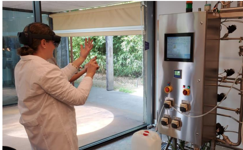
Solución de Realidad Aumentada que ayuda al operario a trabajar con el Biorreactor que se emplea para el cultivo de micelio líquido
