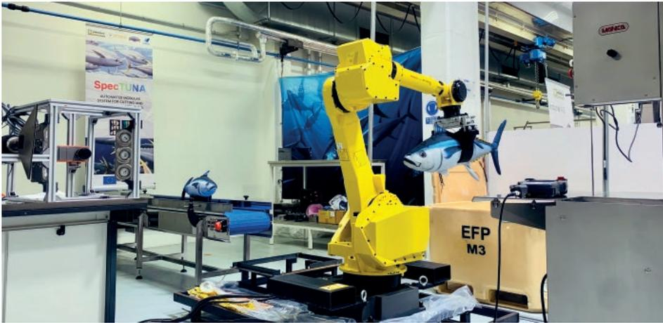
Sistema robotizado de corte y paletizado
