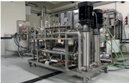
Sistema de filtración con membranas
