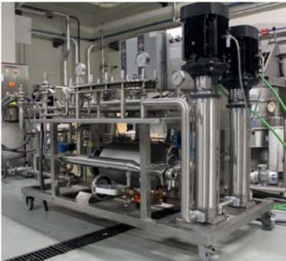
Sistema de filtración con membranas
