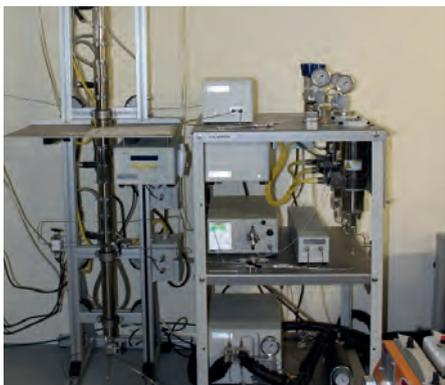
Sistema de extracción por fluidos supercríticos
