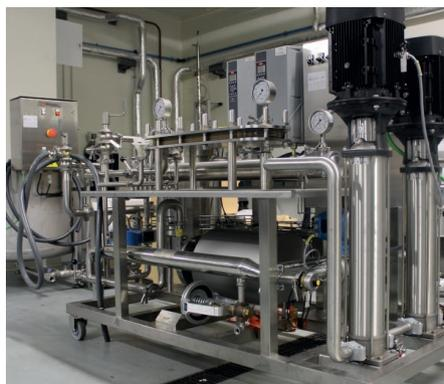
Sistema de filtración con membranas
