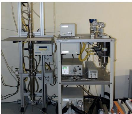
Sistema de extracción por fluidos supercríticos
