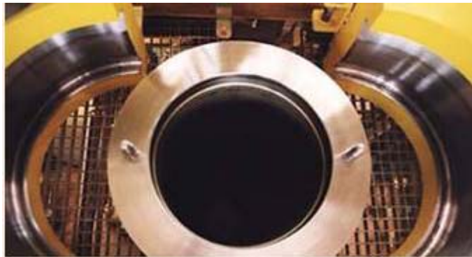
Vista aérea de un extractor. V= 380 litros
