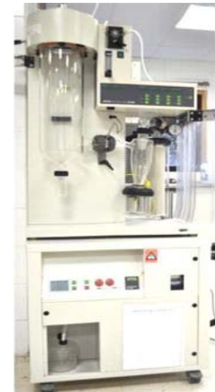
Spray dryer (ANFACO)
